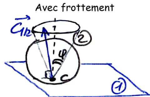
$\vec{C}_{1 \rightarrow 2}$  est comprise dans un cône de demi-angle au sommet  $\varphi$  par rapport à la normale au contact.
